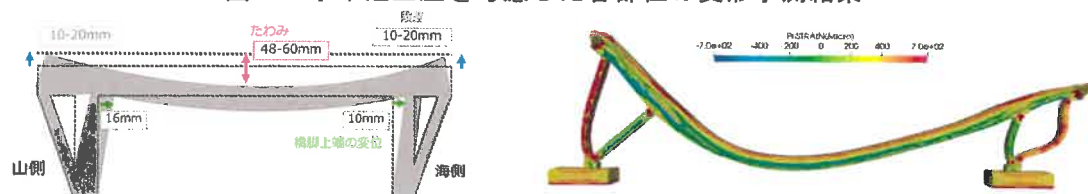
図-2 水平辺土圧を考慮した解析による全体変形(左：実測、右：解析)
