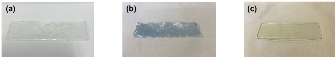
図-3 (a) 色素含有マイクロカプセルとカテコールを含んだ塗料を塗布した直後、(b) 塗布 1 時間後、(c) 色素含有マイクロカプセルのみを混練した塗料。
