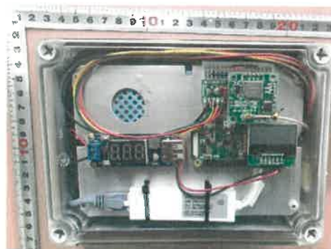
図-1 データ収録システム外観
