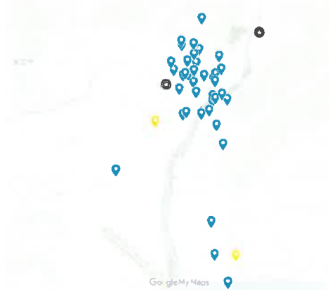
図-2 雷鳴位置推定結果 青色が推定地点、黄色が別観測による推定位置、黒は観測地点を示す。地図情報は Google Earth による。
