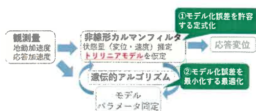
図-1 地震後の高架橋損傷判定例 図-2 提案手法における変位推定アルゴリズム
