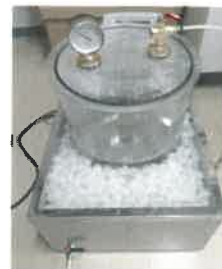
図2 脱気水槽と恒温槽
