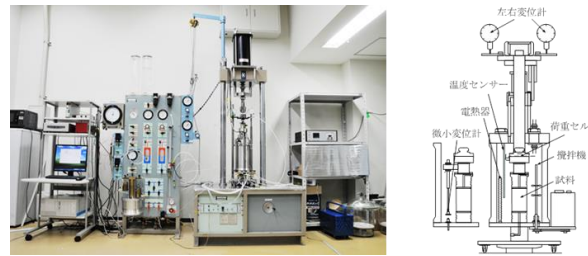
図-1 PC 制御の三軸圧縮・クリープ試験機
