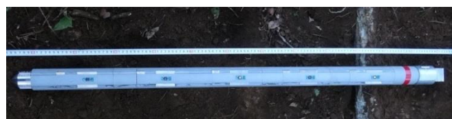
図-2 センサユニット（直径φ50mm×長さ1m）
