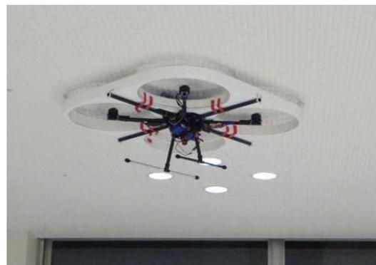
図1. 本研究で開発した天井面に吸着しながら走行できる点検用ドローン(天井面での走行実験の様子)
